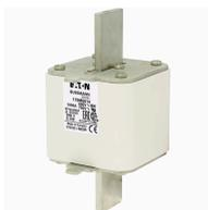
**Cartouche fusible, grande vitesse, 1250 A, AC 660 V, size 3, 91 x 76 x 53 mm, aR, IEC, indicateur de fusion simple**
