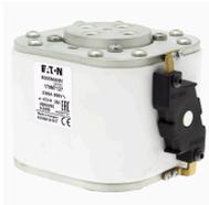
**Cartouche fusible, grande vitesse, 2300 A, AC 800 V, size 4, 120 x 105 x 94 mm, aR, IEC, indicateur de type K**
