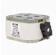
**Cartouche fusible, grande vitesse, 2500 A, AC 660 V, 200 kA, size 4, 120 x 105 x 59 mm, aR, IEC, indicateur de type K**
