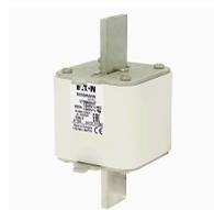
**Cartouche fusible, grande vitesse, 800 A, AC 1000 V, DIN 3, 90 x 75 x 150 mm, aR, DIN, IEC, indicateur de fusion simple, pattes d'extraction conductrices**
