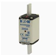
**Cartouche fusible, Basse tension, 200 A, AC 400 V, 120 kA, NH1, gFF, IEC, à double indicateur de fusion, pattes d'extraction isolées**
