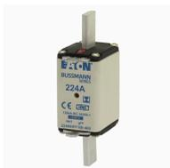
Cartouche fusible, Basse tension, 224 A, AC 400 V, 120 kA, NH1, gFF, IEC, à double indicateur de fusion, pattes d'extraction isolées
