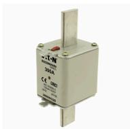
**Cartouche fusible, Basse tension, 300 A, AC 500 V, 120 kA, NH2, gL/gG, IEC, à double indicateur de fusion, pattes d'extraction conductrices**
