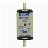
**Cartouche fusible, Basse tension, 63 A, AC 400 V, 80 kA, NH00, gFF, IEC, à double indicateur de fusion, pattes d'extraction isolées**
