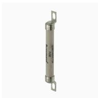
**Cartouche fusible, grande vitesse, 6 A, AC 690 V, 90 kA, BS88, 9 x 75 mm, aR, BS, entraxes de fixation 64,3 mm**
