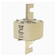
**Cartouche fusible, Basse tension, 800 A, AC 500 V, 120 kA, NH4, gL/gG, IEC, indicateur de fusion simple, pattes d'extraction conductrices**
