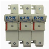
Porte fusible, Basse tension, 125 A, AC 690 V, 22 x 58 mm, 3P + N, IEC, Voyant au néon
