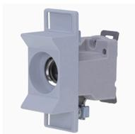
Socle pour fusible, Basse tension, 16 A, AC 400 V, D01, 1P, IEC, montage sur barre DIN, pour 2 fils de connexion de 1,5 à 4 mm
