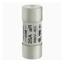
**Cartouche fusible, grande vitesse, 25 A, AC 700 V, 200 kA, 22 x 58 mm, aR, UL, avec percuteur**
