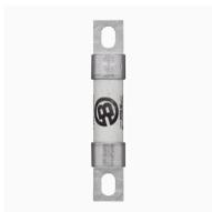
**Cartouche fusible, grande vitesse, 60 A, AC 700 V, DC 700 V, 200 kA, 21 x 112 mm, aR, UL, avec perceur**
