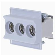
**Socle pour fusible, Basse tension, 63 A, AC 400 V, D02, 3P, IEC, montage sur barre DIN, pour 2 fils de connexion de 2,5 à 25 mm**
