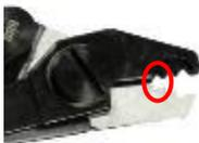
3. Exercer une traction longitudinale, ce qui provoque un glissement entre la partie 125  $\mu$ m et le revêtement secondaire.
