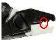
3. Exercer une traction longitudinale, ce qui provoque un glissement entre la partie 125 µm et le revêtement secondaire.
