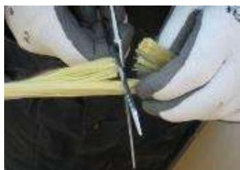
7. A la longueur désirée, à l'aide d'un outil (Jokari/Facom 838.20), réaliser une entaille radiale de 360° **non pénétrante** (pour ne pas abimer les éléments en dessous) sur le tube pour faciliter une casse franche.
