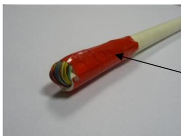
Obturation de la gaine du câble avec capuchon thermo-rétractable
