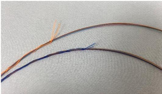
11. Couper l'ensemble des éléments sauf les fibres optiques et retirer tout l'ensemble sur la longueur à dénuder (Gaine + Renforts + Filins)
