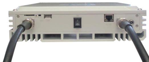
Réaliser la connexion en positionnant le connecteur N mâle du câble RF sur le port MS.
