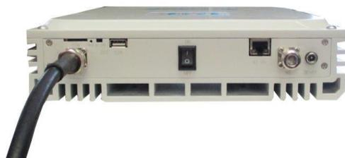
Retirez les bouchons sur les ports BTS et MS.
