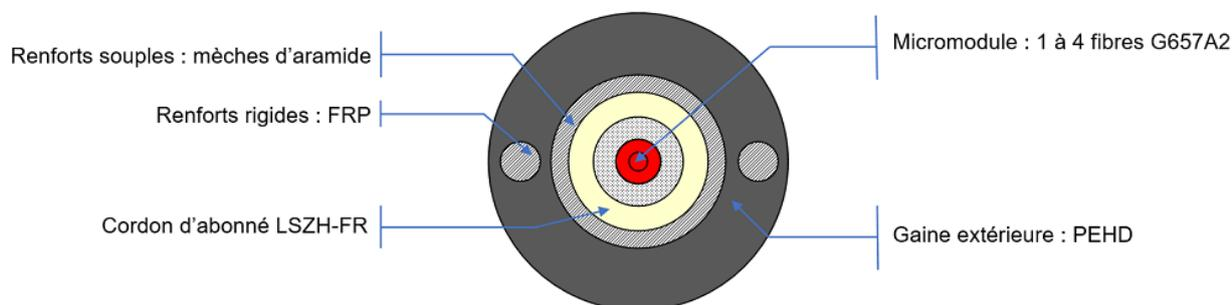
Pose en aérien, en conduite ou en façade. Pose en intérieur en enlevant la gaine PEHD. Le câble d'abonné LSOH peut alors être posé en goulotte, collé ou tiré jusqu'à la prise optique.
