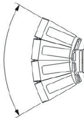
L'illustration montre le système d'enceintes avec un angle de directivité réglé à 60° (paramètres d'usine).
