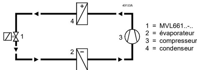
Le contrôle électronique de la surchauffe est effectué par des appareils de régulation supplémentaires, par ex. PolyCool.
