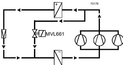
Convient pour les grandes installations de climatisation où des variations de température inadmissibles pourraient se produire entre les différents étages du compresseur.
