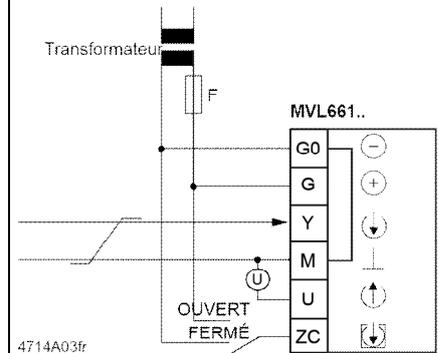
**Raccordement à un régulateur avec sortie 3 fils**
