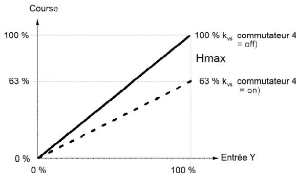
Lorsque la réduction du  $k_{vs}$  est active (commutateur DIL 4 sur ON), la course est limitée à 63 %. A ces 63 % de course mécanique correspond donc un signal de sortie et d'entrée de 10 V. Si l'on augmente la limitation de course, à 80 % par exemple, la course minimale est réglée sur  $0,63 \times 0,80 = 0,50$  de course mécanique.
