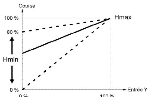
Pour assurer un refroidissement et un retour d'huile suffisants au niveau du compresseur, on peut prévoir une vanne de réinjection avec régulateur de gaz chaud, un bipasse sur la vanne ou encore réduire l'ouverture de la vanne d'aspiration. L'ouverture minimale de la vanne peut être sélectionnée via le régulateur et le signal Y ou directement sur la vanne à l'aide du potentiomètre Rv.
