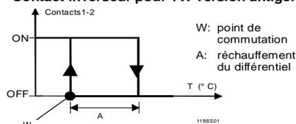
En cas de refroidissement de la sonde à une température inférieure à -20°C environ, le circuit de commande s'ouvre. Toutefois, il se referme automatique lorsque la température remonte.
