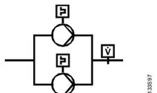
Commande de pompes jumelées avec surveillance d'écoulement et de surcharge
