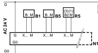
**Schéma électrique 2 : Circuit de mesure avec sonde active et potentiomètre de consigne actif**
