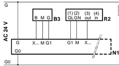
**Schémas de raccordement 3 et 4: circuit de mesure avec analyse CO2/COV**
