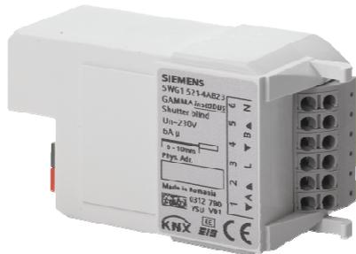
L'actionneur de store RL521/23 est un appareil KNX avec 2 canaux de gestion de stores. L'appareil est installé dans un boîtier AP 118 ou un boîtier AP 641. Le bus est raccordé via un bornier. L'électronique de l'appareil est alimentée via la tension du bus. Le module RL521/23 peut être utilisé pour commander des stores, des volets roulants, des auvents, des fenêtres ou des portes.
