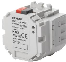
Le module de sortie binaire (relais) UP 510/13 est un appareil KNX avec 2 sorties de commutation et une interface utilisateur bus. L'appareil est installé dans une boîte d'encastrement (60 mm Ø, profondeur 60 mm). Le bus est connecté via un bornier bus. L'électronique de l'actionneur est alimentée via la tension du bus.
