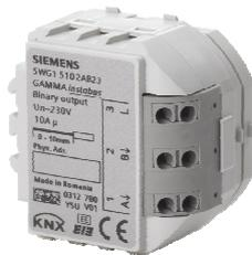
Le module de sortie binaire (relais) RS 510/23 est un appareil KNX disposant de 2 sorties de commutation. L'appareil est installé dans un boîtier AP 118 ou un boîtier AP 641. Le bus est raccordé via un bornier. L'électronique de l'appareil est alimentée via la tension du bus.
