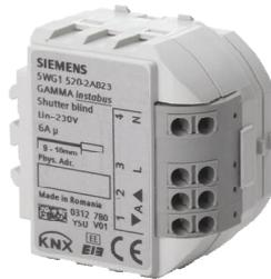
L'actionneur de store RS520/23 est un appareil KNX avec 1 canal de gestion de stores. L'appareil est installé dans un boîtier AP 118 ou un boîtier AP 641. Le bus est raccordé via un bornier. L'électronique de l'appareil est alimentée via la tension du bus. Le module RS520/23 peut être utilisé pour commander des stores, des volets roulants, des auvents, des fenêtres ou des portes.
