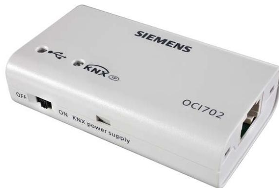
L'interface USB-KNX OCI702 sert à fournir une connexion USB-KNX pour accéder aux outils, à partir d'un système Microsoft Windows PC jusqu'au réseau KNX. Il se compose du service interface OCI702 mais également de plusieurs câbles et accessoires, y compris les attaches de câble.
