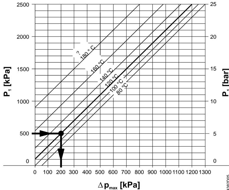
$\Delta p_{\max}$  = Pression différentielle sur la vanne à boisseau sphérique presque fermée qui permet d'éviter la cavitation dans une large mesure
