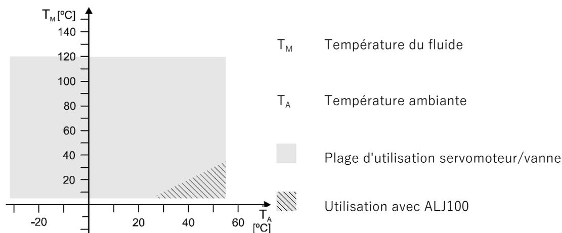
N'utiliser les servomoteurs GDB..., GSD..., GQD.. et GDD.. qu'avec des températures de fluide  $> +5^\circ \text{C}$ .
