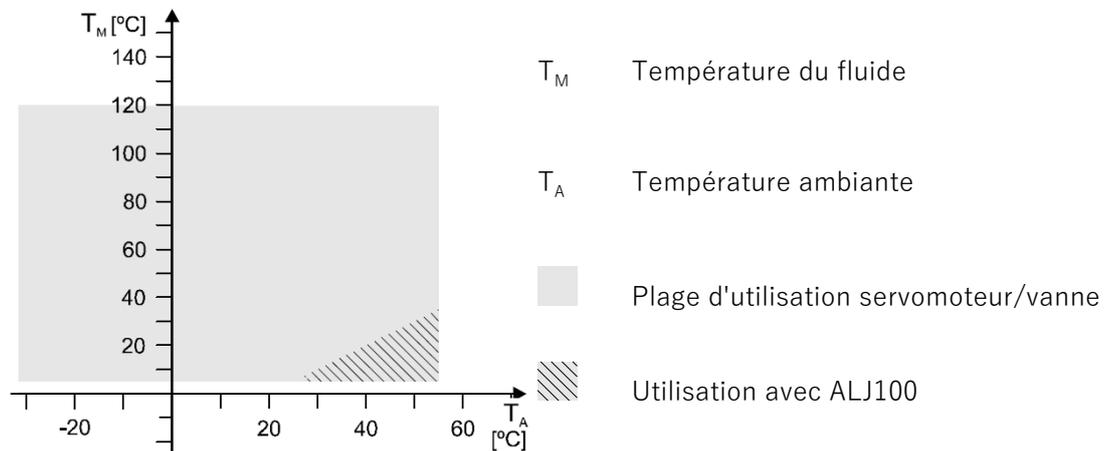
N'utiliser les servomoteurs GDB.., GDD.., GSD.. et GQD.. qu'avec des températures de fluide  $> +5^\circ \text{C}$ .
