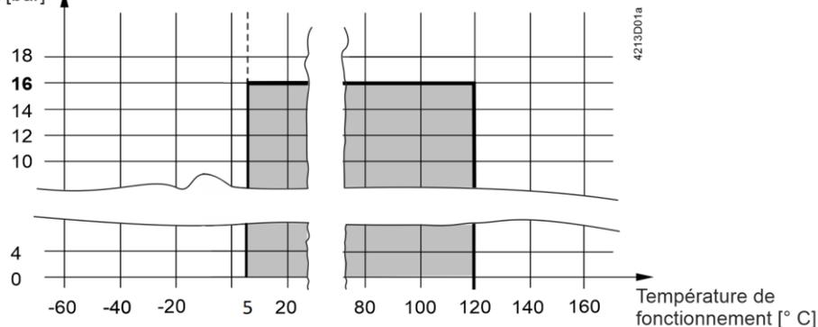
Pression de fonctionnement et température du fluide selon ISO 7005
