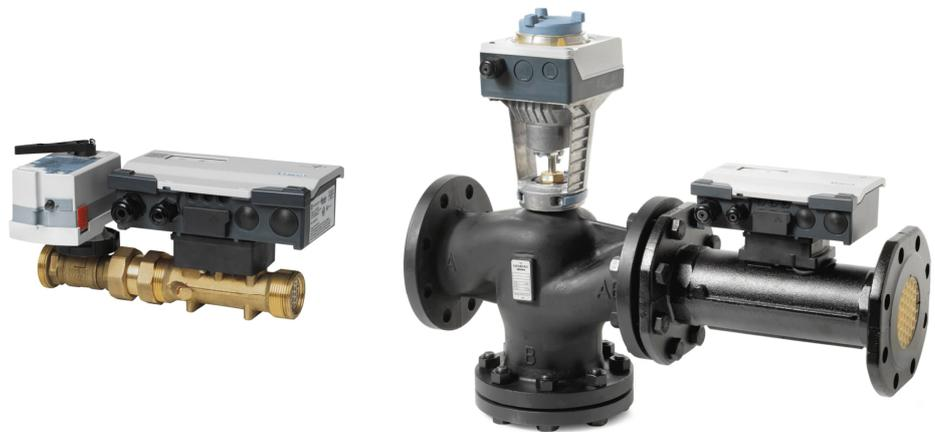
**Vanne de régulation deux voies avec mesure des données d'énergie intégrée pour des applications de CVC dans des installations de ventilation, de climatisation et des circuits de pré-régulation. Régulation dynamique du débit volumique pilotée par sonde.**
