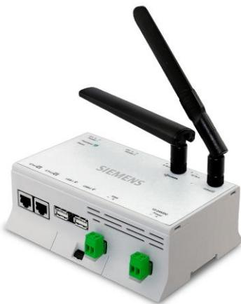
**La Connect Box est une solution IoT universelle et ouverte pour connecter et surveiller des bâtiment de petite et moyenne dimension**
