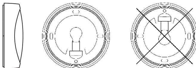
L'embase du luminaire doit être impérativement être fixée par 4 vis
