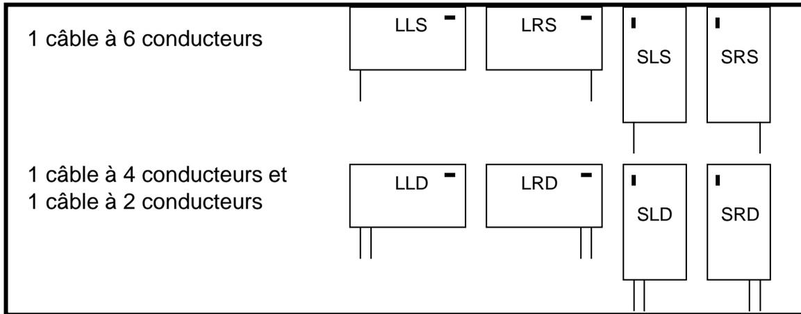
Exemples d'applications avec différentes zones de détection
