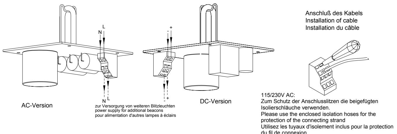
Nach Anschluß der Betriebsspannung, Aufsetzen und Befestigung des Gehäuses ist die Blitzleuchte einsatzbereit. Mit einem sich anschließenden Test ist die einwandfreie Funktion sicherzustellen.
