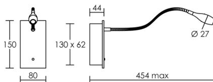
Support acier/Tête aluminium. Interrupteur et **variateur**. Alimentation 500 mA intégrée. Montage en applique.
