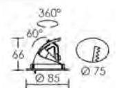
Corps et réflecteur aluminium. Basculant. Blanc. Alimentation 350mA, classe 2, IP20. Spot classe 3.
