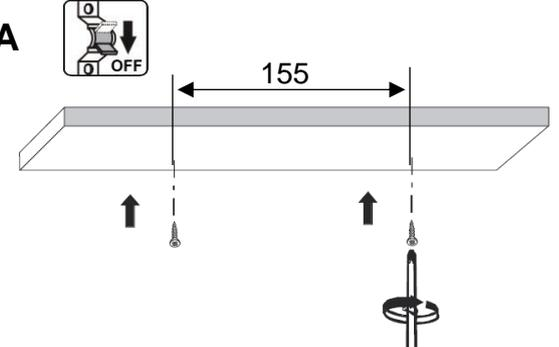
Fixez les écrous sur le support en respectant un entraxe de 155 mm.
