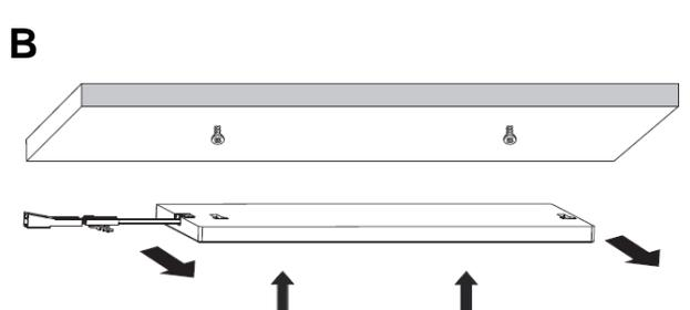
Faire glisser le luminaire sur les vis prémontées.
