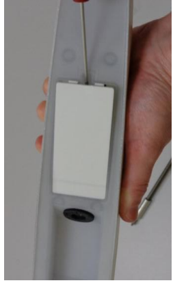
Ouvrir la trappe à l'aide d'un tournevis plat.
