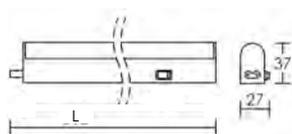
Corps polycarbonate. Interrupteur. Cordon 1,8 m, fiche 6A. Raccord de 15 cm. Possibilité de raccordement en ligne avec connecteur fourni. Clips de fixation inclus.
