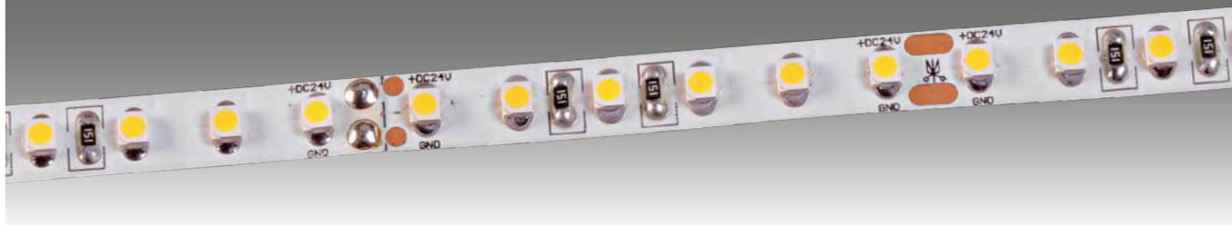
Ruban adhésif, LED « 3528 » (IRC 80), non-protégé 120 LED/m, 0,25 W/m (pas de 6 LED 50 mm). Largeur 8 mm. Câble LIYY 2x 0,5 mm<sup>2</sup> 1 m soudé. Peut être coupée tous les 6 LED. Une connexion supplémentaire (55001) incluse.
