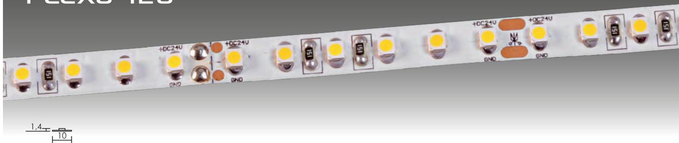
**Ruban adhésif, LED « 3528 » (IRC 80), non-protégé 120 LED/m, 9,2 W/m (pas de 6 LED 50 mm).**
