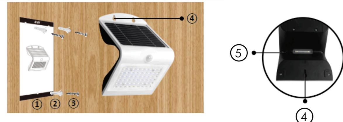
**La hauteur d'installation recommandée est de 2 à 4 mètres**
