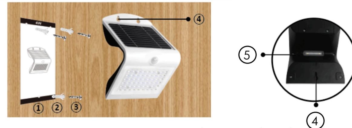
**La hauteur d'installation recommandée est de 2 à 4 mètres**
