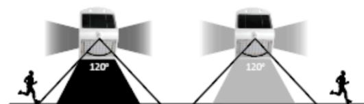
Lorsque la puissance de la batterie est supérieure à 30 % : la lampe s'allume automatiquement la nuit et passe à la pleine luminosité lorsqu'un mouvement est détecté dans un rayon de 6 mètres, puis diminue pour diminuer la luminosité : les deux lumières s'allument après 20 secondes d'inactivité.
