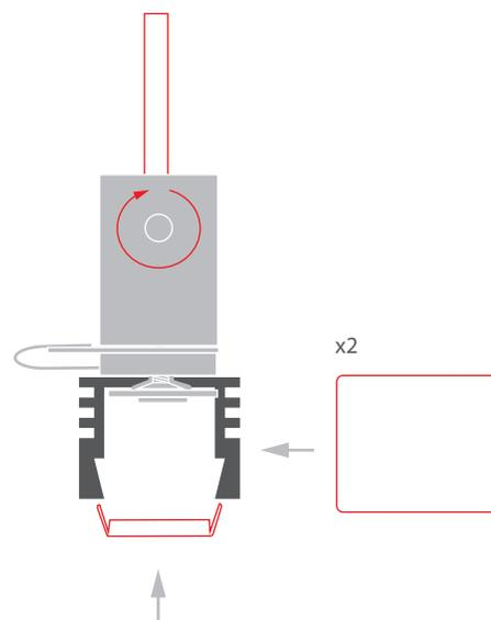
**5.** Installez les pièces de fixation de plafond W-KG-Z. La notice d'installation des pièces de fixation peut être téléchargée sur [www.klusdesign.eu](http://www.klusdesign.eu). Raccordez les câbles, un pour chaque conducteur d'alimentation, aux pièces de fixation. Les câbles doivent traverser le trou prépercé juste en dessous du cache de la pièce de fixation.
