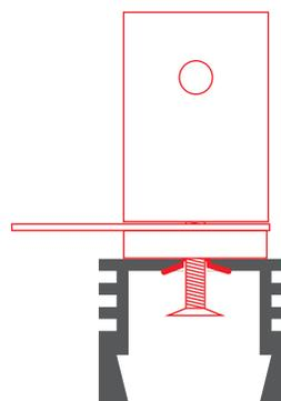
**3.** Montez le ruban à LED dans le profilé et faites passer les câbles à travers les trous prépercés. Puis dirigez-les vers les connecteurs des pièces de fixation DP-ZZ. Chaque trou doit laisser passer un câble avec un conducteur d'alimentation, le ruban à LED doit être coupé avant l'installation pour que les fils puissent être facilement dirigés vers les trous.
