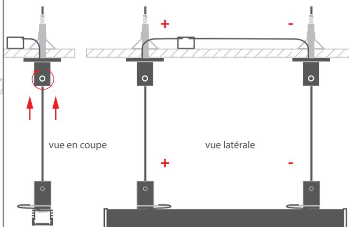
**1.** Percez un trou de 5 mm de diamètre dans le profilé choisi. Prévoyez 3 trous pour monter les pièces de fixation et faire passer les câbles d'alimentation. Chanfreinez les 2 trous pour les pièces de fixation afin de pouvoir y loger la tête de vis en plastique.
