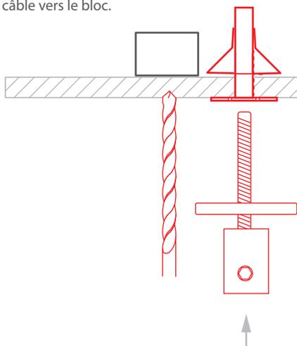
**6.** Montez le luminaire muni des tiges dans les pièces de fixation de plafond. Raccordez le câble au bloc d'alimentation, en le faisant passer par un trou préalablement percé dans le plafond.
