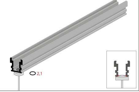
Chanfreinez le trou pour cacher l'élément de raccord de câble étanche (2.1) dans la cavité.
