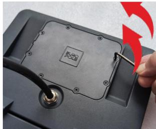
**NL** Draai de schroeven van het batterijkompartment aan de achterkant van het toestel los (Torx nr. 10).
